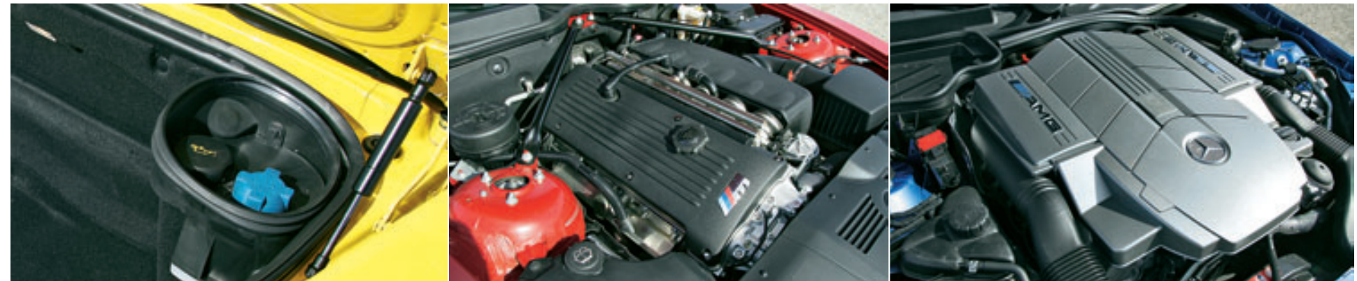
Der lauffruhige Porsche-Boxer agiert unter dem Kofferraum Der BMW-Reihensechser lebt von Drehzahlen, 8000 /min sind möglich Der V8 im Mercedes liefert viel Schub aus dem Drehzahlkeller
