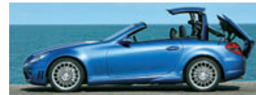
Das aufwändige Stahlklappdach des Mercedes ist nach 21 Sekunden geschlossen. Öffnen dauert eine Sekunde länger
